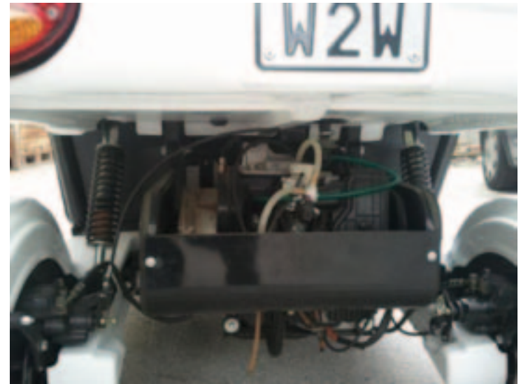
Ricarica della batteria mediante motore interno a bioetanolo
